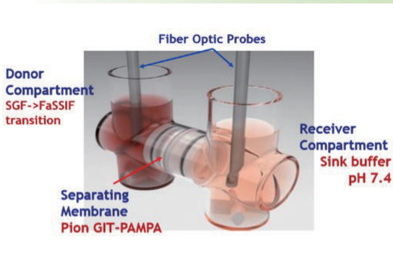
懸濁液、顆粒、混合末におけるAPIの溶出と溶解性、膜透過性を同時に測定します
